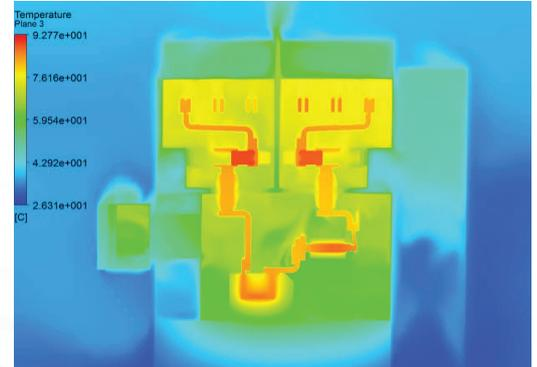
Thermische Simulation eines GIS -Felds bei 2500 A, 50 Hz
