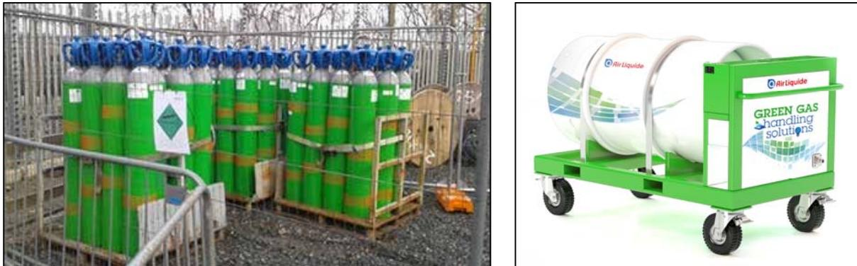
Bild 3: Vorgemischtes Gas zur Erstbefüllung in 50l Flaschen (links) und in 500l Flaschen (rechts)
