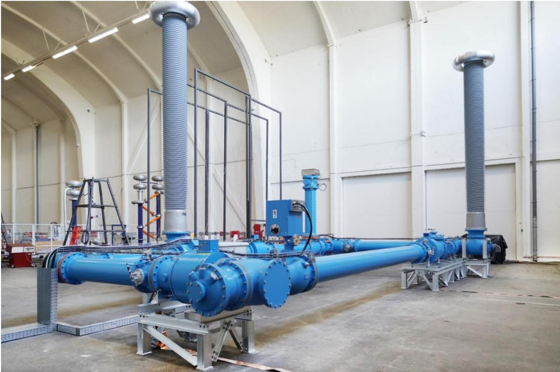
*Abbildung 4. GIS-Prototyp-Installationstest: Foto vom Aufbau*
