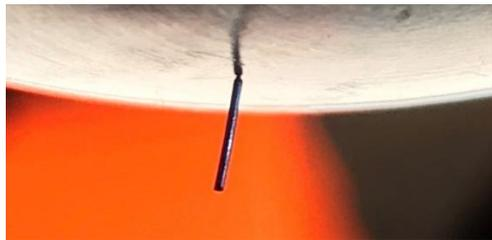
Abbildung 11. Während der Fireflybewegung an den blanken Innenleiter angeschweißte 4 mm Zylinderpartikel
