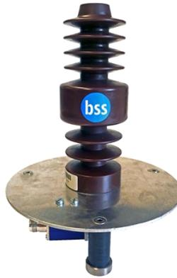
*Bild 2. Foto des Mittelspannungssensors, konstruiert aus einem Mittelspannungsisolator mit integrierter Kapazität und einer sekundären Kapazität am Abgriff.*
