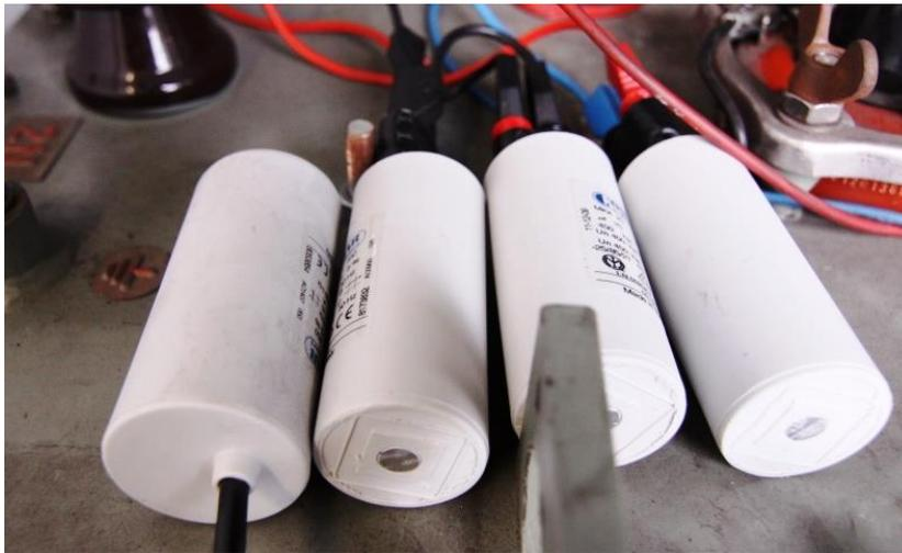
Abbildung 4: Blindleistungskompensation mit 4 x 25µF Kondensatoren.
