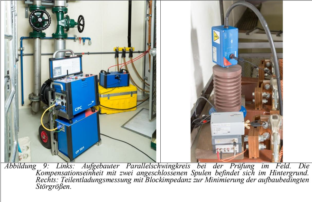
*Abbildung 9: Links: Aufgebauter Parallelschwingkreis bei der Prüfung im Feld. Die Kompensationseinheit mit zwei angeschlossenen Spulen befindet sich im Hintergrund. Rechts: Teilentladungsmessung mit Blockimpedanz zur Minimierung der aufbaubedingten Störgrößen.*
