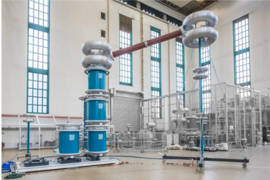
Abbildung 4: 1200 kV DC-Prüfsystem mit Wasserentladewiderstand (rechts) aus Abbildung 3 während der Werksabnahme
