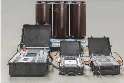
Bild 4: Prüfquelle in drei Boxen (von links: Box 1 – Box 2 – Box 3)
