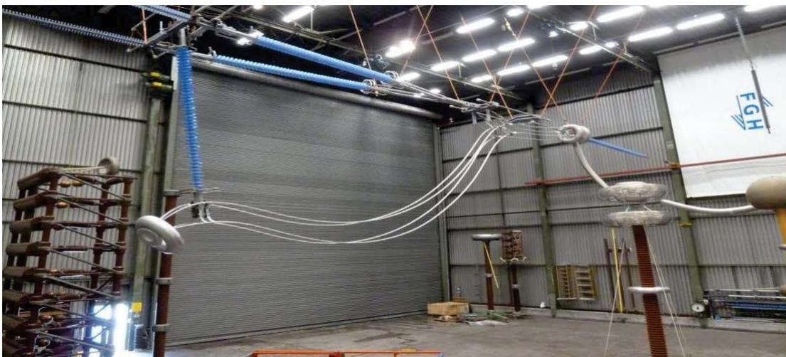
Versuchsaufbau RIV-Prüfung Abspannkette
