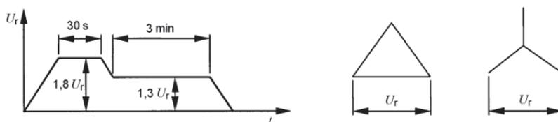
Bild 1: Spannungsverlauf bei der Teilentladungs-Stückprüfung [1]
