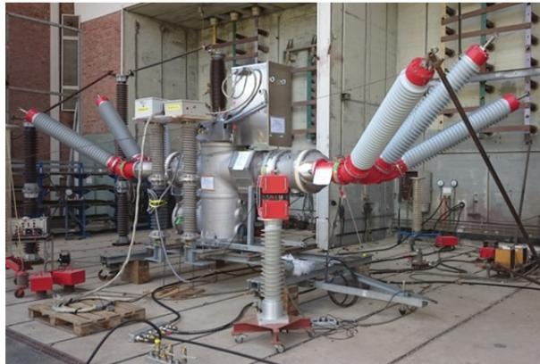
Bild 11: Leistungsprüfung am Leistungsschalter
