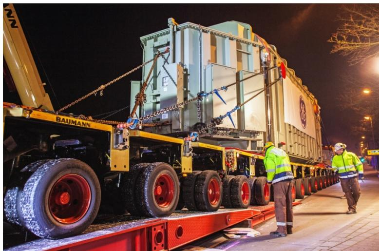
*Bild 1: 684-MVA-Leistungstransformator für das HGÜ-Projekt DolWin 3 [3] mit einem Transportgewicht von mehr als 450 Tonnen*
