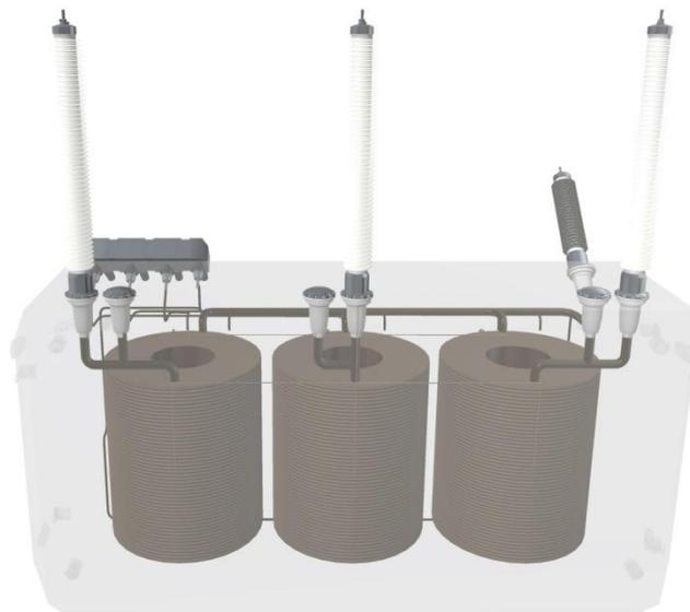
*Bild 16: Papierfreie Durchführungen aus Resin Impregnated Synthetic (RIS)*
