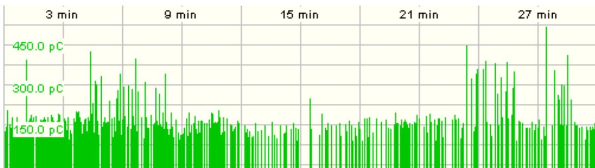
Bild 9: Diagramm der Impuls über die Messzeit mit deaktivierter Brückenschaltung
