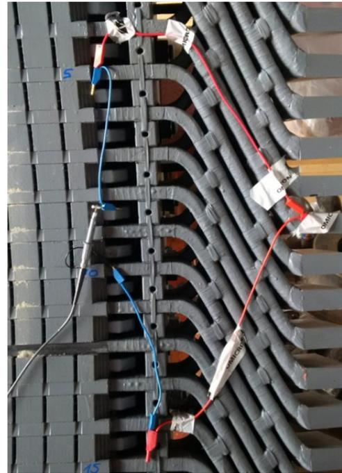
Abbildung 8: Messanordnung Überkopplung im Wickelkopf
