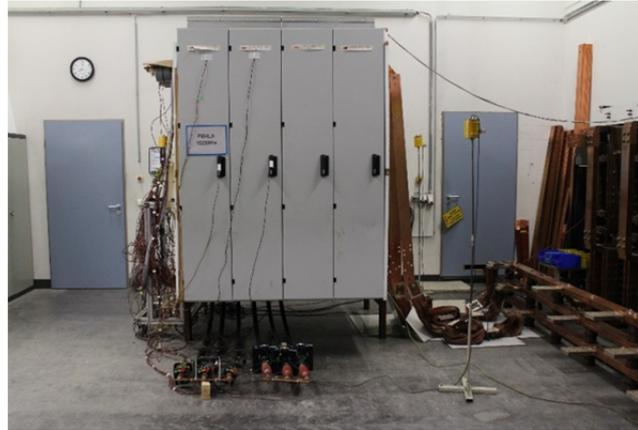
Abb. 9 MS-GIS, Erwärmungsprüfung
