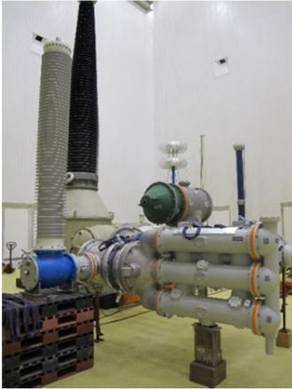
Abb. 10 HS-GIS, dielektrische Prüfung
