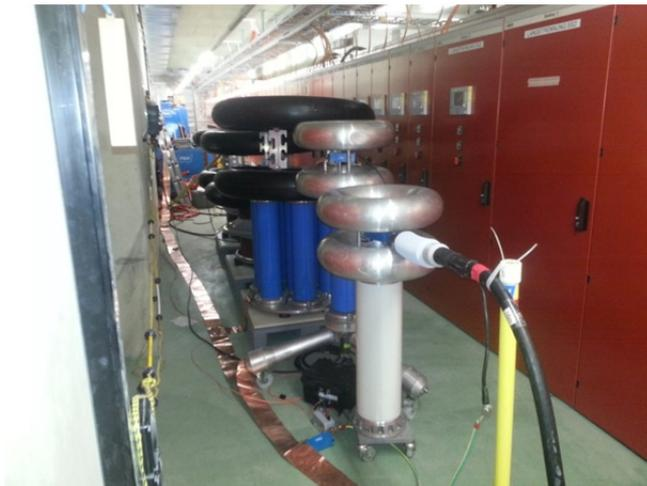
Abb. 28 Hochspannungsprüfkomponenten mit TE-Messsystem
