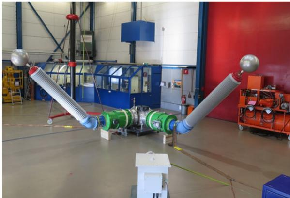
Bild 10: Dielektrische Prüfung eines Trenners
