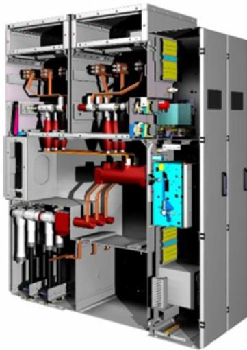
Abb. 16 CAD-Bild eines Feldes Typ ZX2
