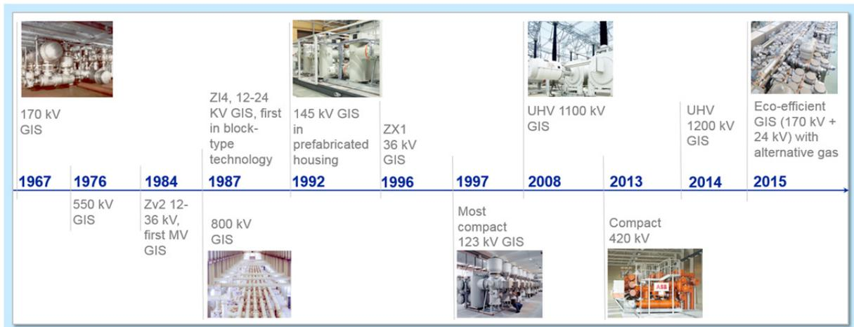
Abb. 2 Entwicklung der Gasisolierten Schaltanlagen
