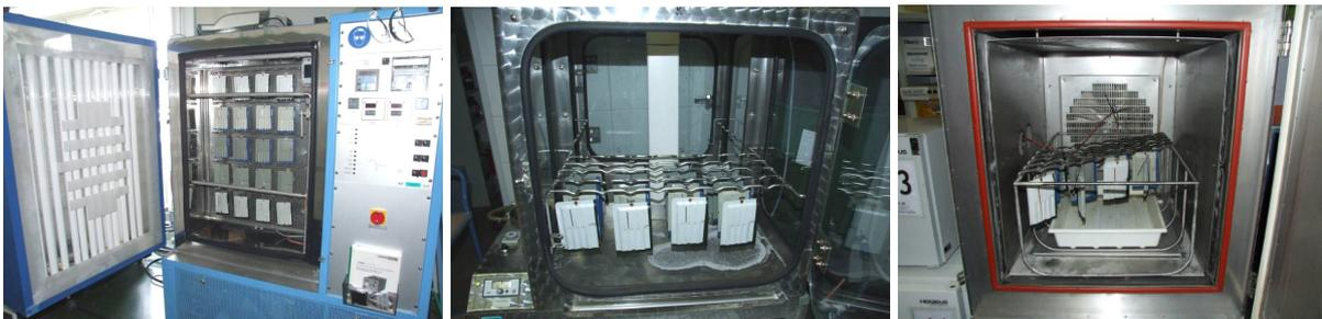
**Bild 7:** Tests an KTL-Proben gemäß ISO 20340, links: Bewitterungsprüfkammer (UV-/Kondensationstests), Mitte: Salzsprühnebeltests, rechts: Klimaprüfkammer
