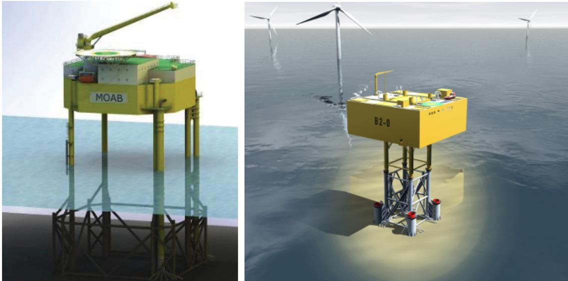
*Bild 20: AC Offshore-Plattformen, links: Global Tech 1 in der deutschen Nordsee mit vier 120-MVA-Leistungstransformatoren, rechts: Neuer Konzeptentwurf für Baltic 2 – eine selbstschwimmende selbsterrichtende Plattformlösung mit zwei 150-MVA-Leistungstransformatoren und zwei 52-Mvar-Kompensations-Drosselspulen*
