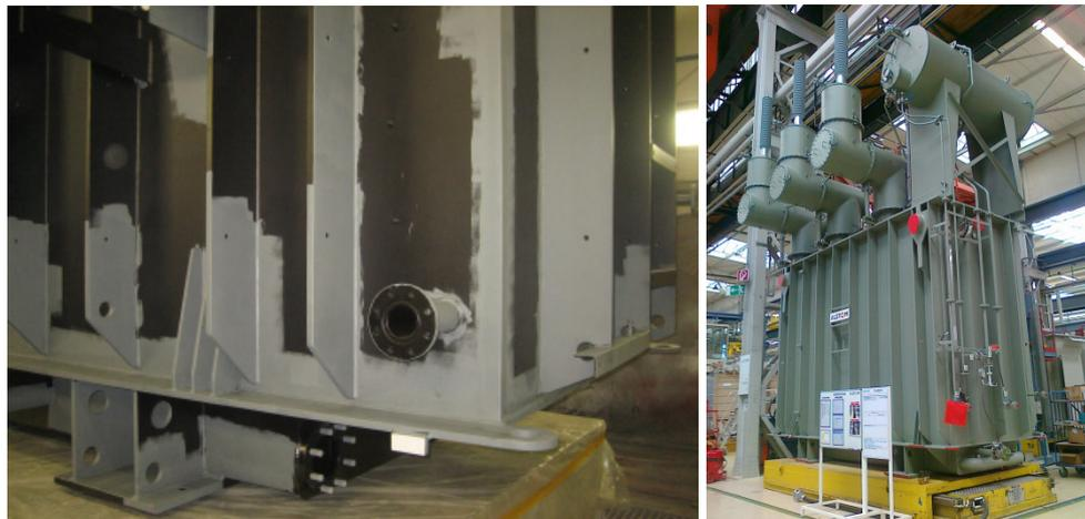
*Bild 10: Kompletter Kessel eines 120-MVA-Transformators mit KTL-Behandlung, links: Teilansicht des Kessels mit bereits aufgetragenem zusätzlichem Kantenschutz (graue Farbe), rechts: zur Prüfung komplett aufgerüstet im Herstellerwerk*
