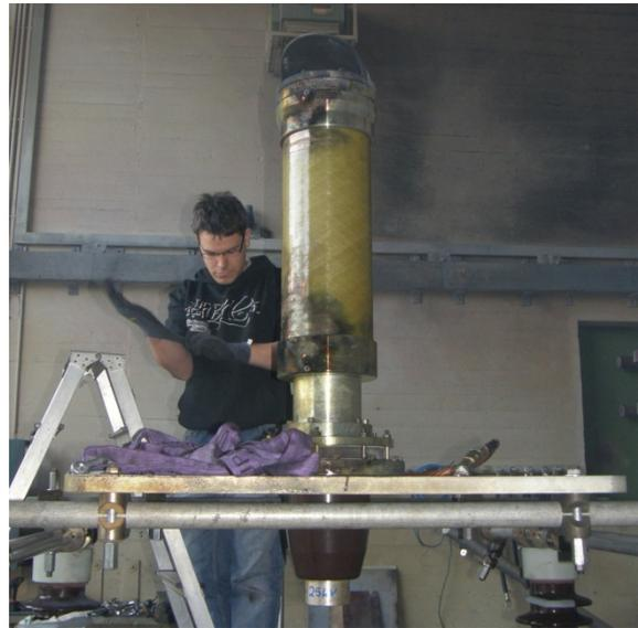
Abbildung 12 Steckbarer feststoffisolierter Überspannungsableiter vor und nach Kurzschlussprüfung mit 40 kA / 200 ms
