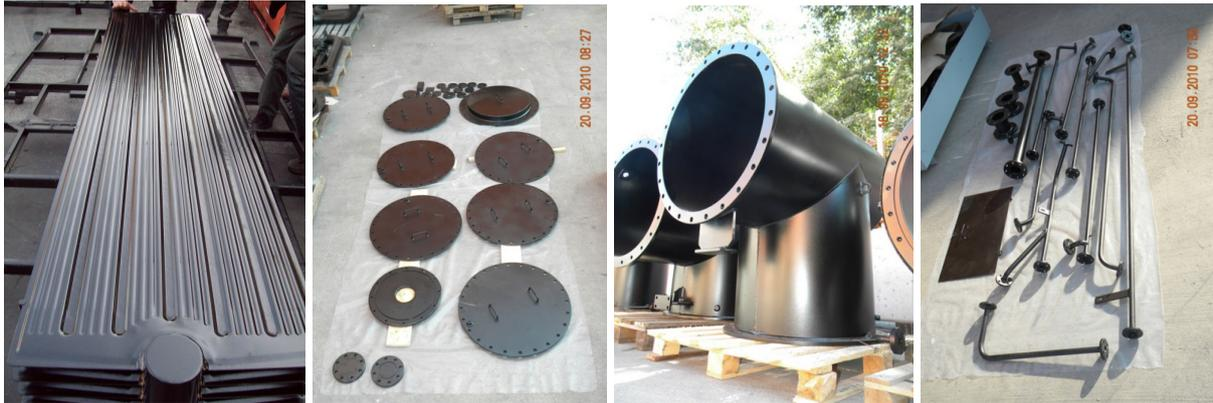
*Bild 9: KTL-beschichtete Teile mit sehr glatter Oberfläche, von links nach rechts: Radiator, Flansche, Kabelanschlusskästen und Rohrleitungen*
