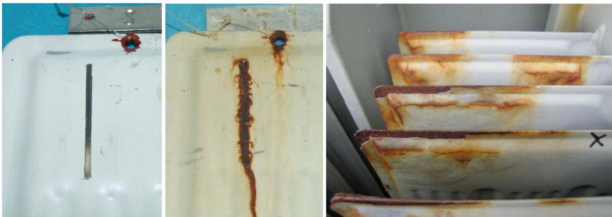
**Bild 8:** KTL-Proben mit Deckanstrich, links: Probe mit 2 mm breitem Ritz zur Beurteilung der Unterrostung, Mitte: nach 175 Tagen (4200 Stunden), beeindruckende Rostbildung und Unterwanderung des Korrosionsschutzes am definierten Kratzer, Tests gemäß ISO 20340 wurden bestanden; rechts zum Vergleich: Versuchsradiatoren (ohne KTL) nach 8 Jahren unter Offshore-Bedingungen ohne Pflege des Korrosionsschutzes
