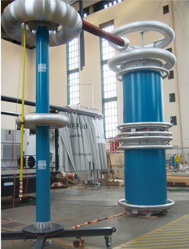
Abbildung 2: Prüfaufbau zur Vor-Ort-Prüfung mit Prüfsystem GPM 30/800
