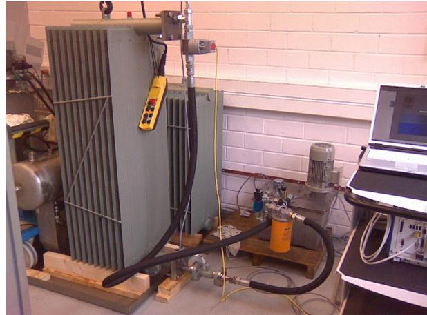
*Bild 13: Versuchsaufbau bei der Maschinenfabrik Reinhausen zu Untersuchungen an Dehnradiatoren*
