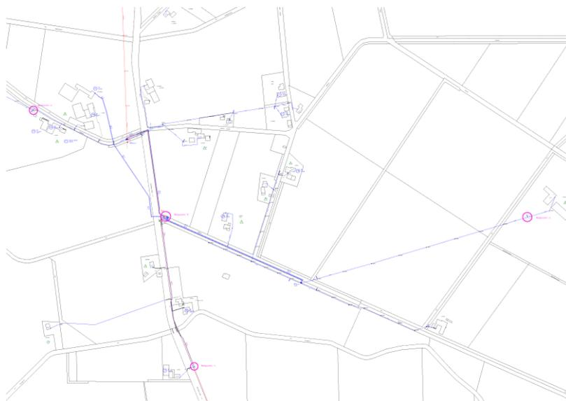
**Bild 7:** Vereinfachte Netzstruktur Ortsnetz Voltlage
