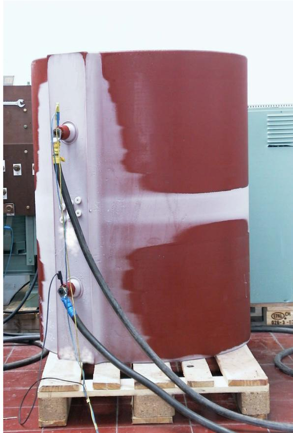
Der Transformator wird auf  $-25^{\circ}\text{C}$  abgekühlt und danach bis zur Nenntemperatur mit doppeltem Nennstrom aufgeheizt.
