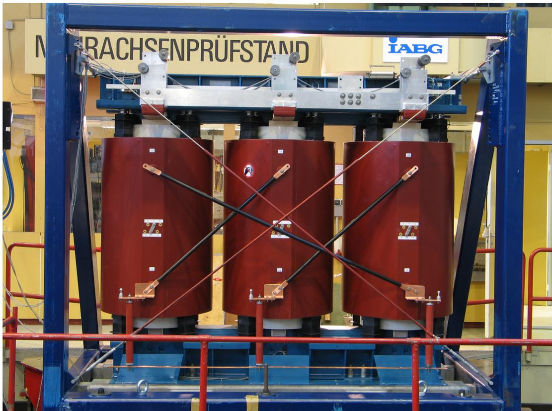
Dazu werden Beschleunigungssensoren an verschiedenen Stellen am Transformator angebracht.
