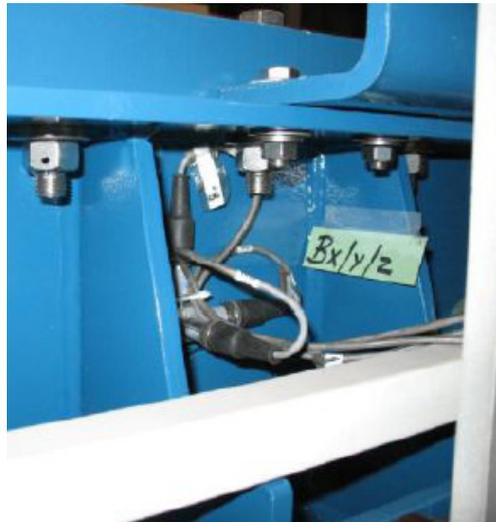
Vor den Prüfungen werden die Eigenfrequenzen des Transformators bestimmt.
