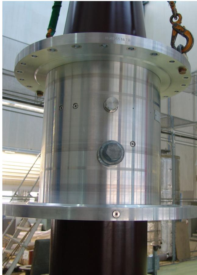
Abbildung 7 / „Voltage Tap“ und 2kV- Messanschluss
