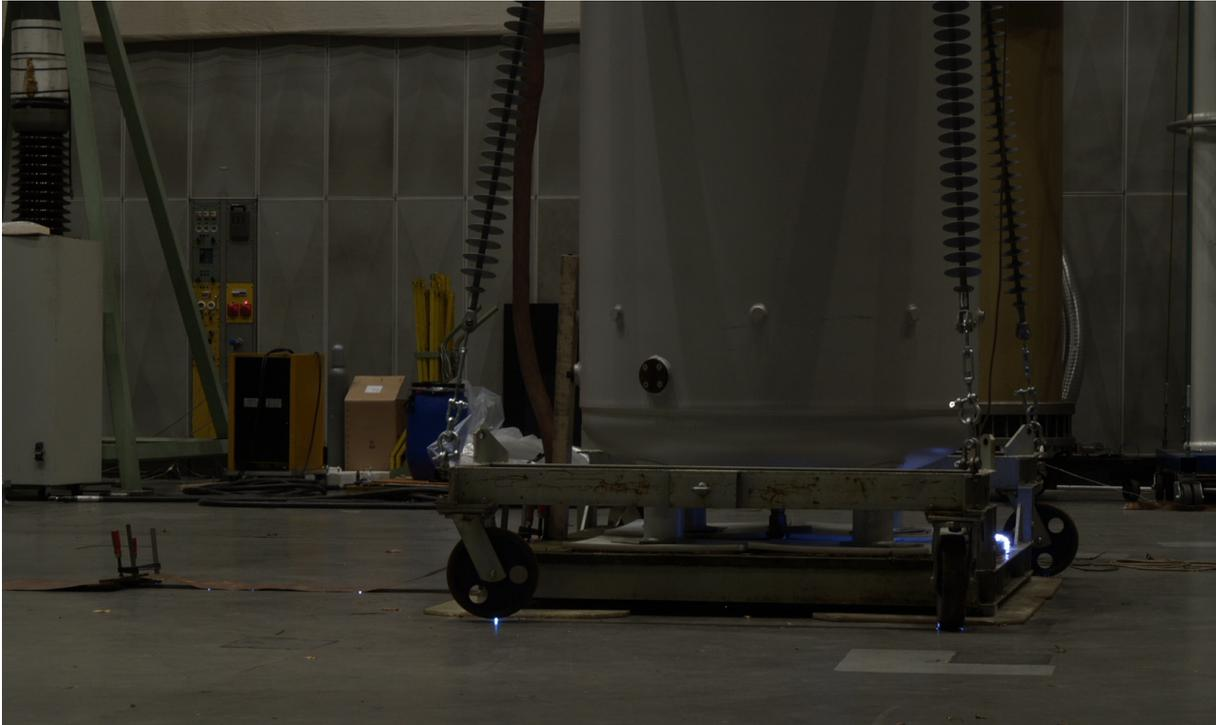
Abbildung 10b Entladungen an den Rädern und am Öltank
