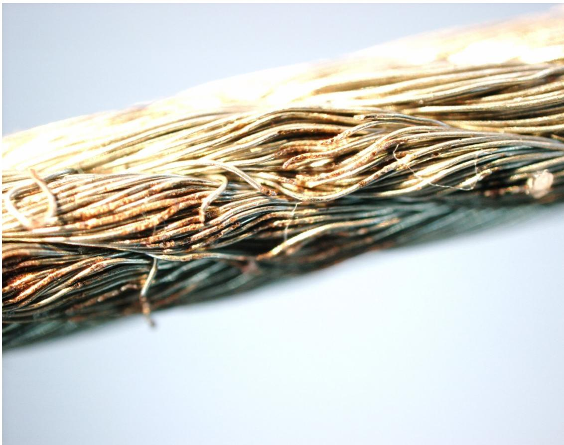
*Abbildung 8b / Messanschlusslitze nach den Versuchen in vergrößerter Darstellung*
