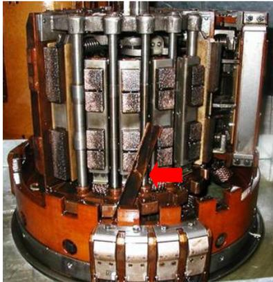
Bild 4: blockierter Lastumschalter
