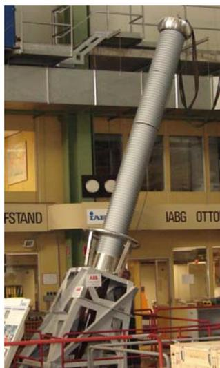
Abbildung 4: 550 kV SeismicRIP<sup>®</sup> Transformatordurchführung installiert auf dem Erdbeben-Simulator-Tisch
