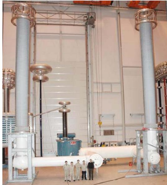
Bild 14 Versuchsaufbau für das Schalten von Steuerkondensatoren im Leistungsschalter durch einen Trenner entsprechend IEC 62271-102 im Hochspannungslabor STRI
