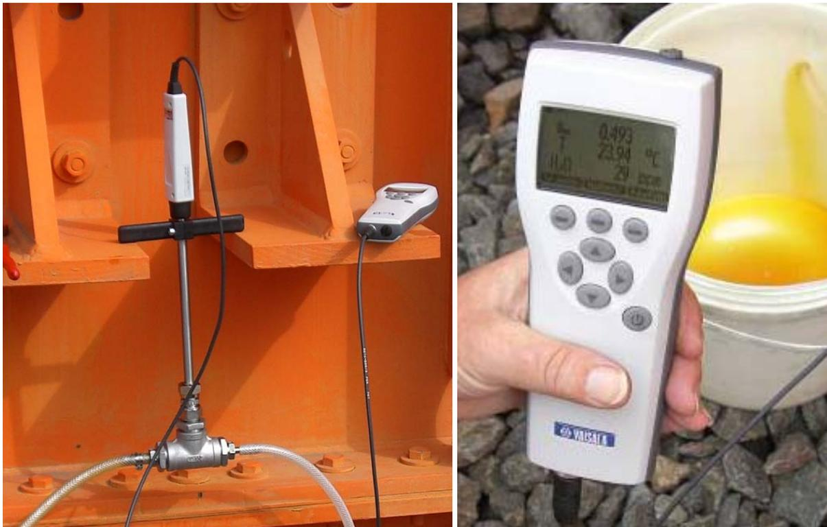
**Bild 11** Feuchtebestimmung mit Vaisala MM70 während der Ölprobennahme. System noch nicht im Gleichgewicht, Anzeigewerte unrealistisch hoch.
