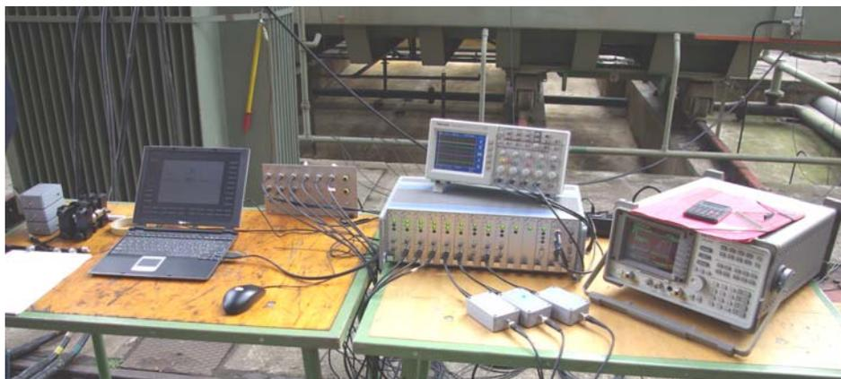
Bild 4.4 TE- Messung am Blocktransformator
