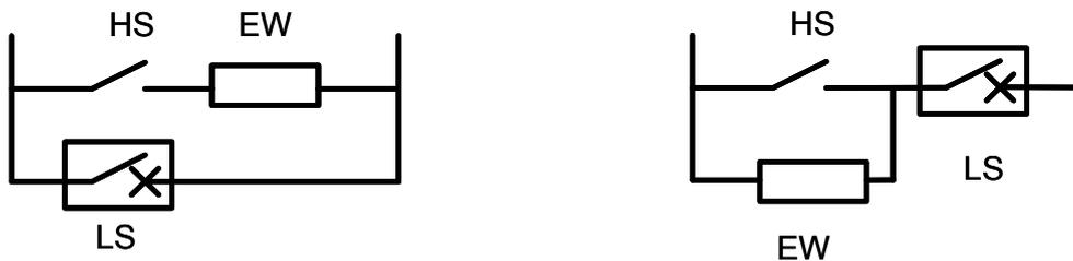
Bild 3 Prinzipschaltbild eines Leistungsschalters (LS) mit Einschaltwiderstand (EW) und Hilfsschalter (HS)
