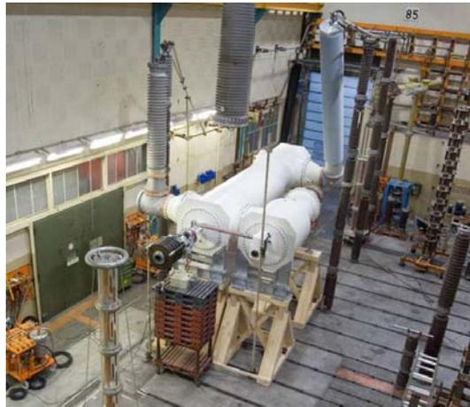
Bild 16 1100 kV Leistungsschalter im Leistungsversuchfeld bei einem Vollpoltest mit isolierter Kapselung
