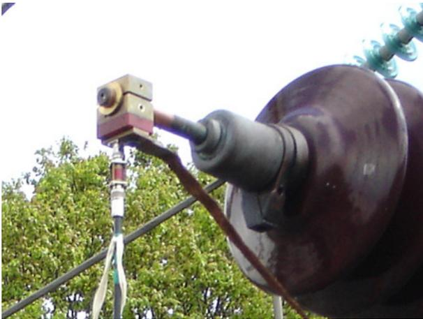
Abb. 14 a): Massiver Messing-Klotz als N-Trafoklemme-Adapter
