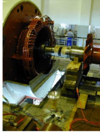
Auskopplungseinheit:  $C_K = 2 \text{ nF}$
