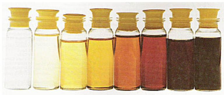
Abbildung 25: Regenerierstufen von gealtertem Öl
