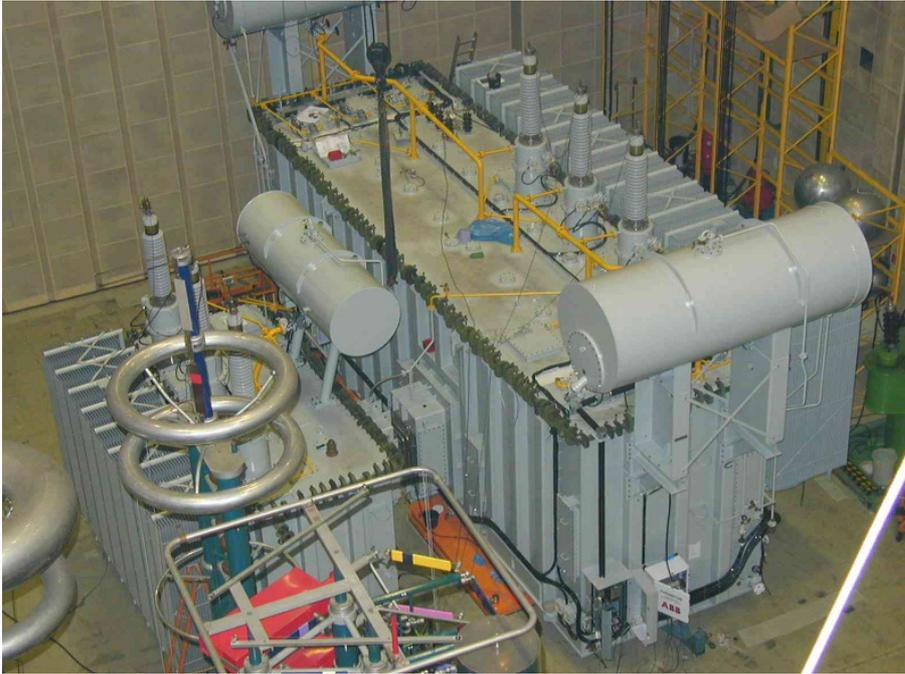
Abbildung 9: 450 MVA, 138 / 138 kV, +/- 58°, Extended Delta Konzept, mit separater Drossel. Abmessungen ca. 14.7 x 10.8 m, Masse ca. 553.000 kg
