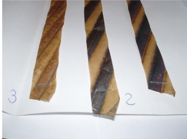
**Fig. 2:** Kupfer(I)sulfid Schichten auf Wicklungspapier
