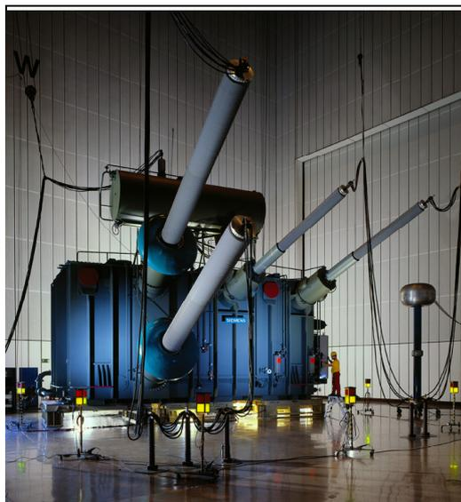
Bild 8: Anordnung der Leitungsführung der Ventilseite eines 345 MVAYd/Yy Einphasentransformator
