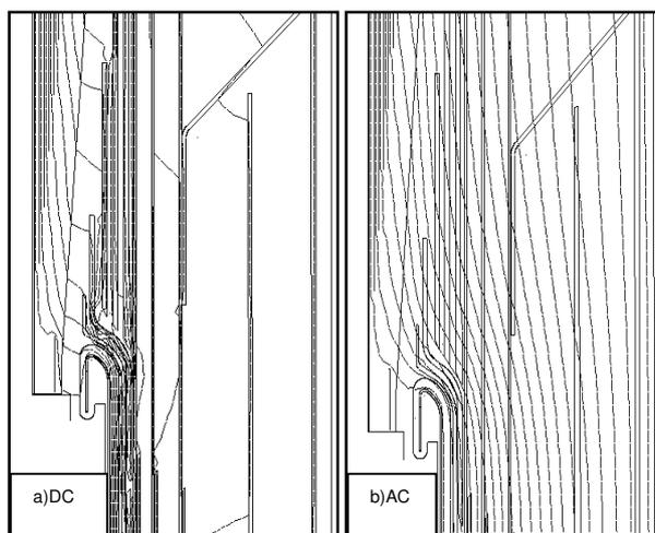
Bild 9 a)b) Feldbild bei DC und AC
