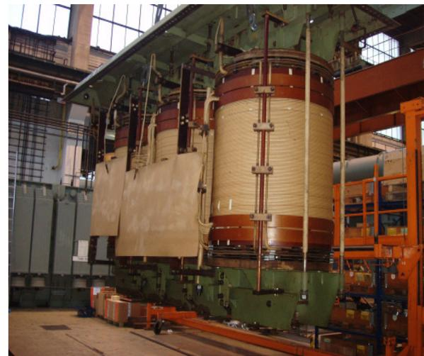
**Bild 6:** Aktivteil nach der Trocknung
