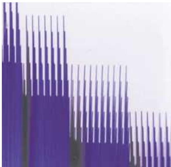
Bild 1: Step-Lap-Schichtung
