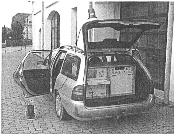
Bild 11: Mobiles CDA-Prüfsystem für die TE-Diagnose von Mittelspannungskabeln bis 30 kV
