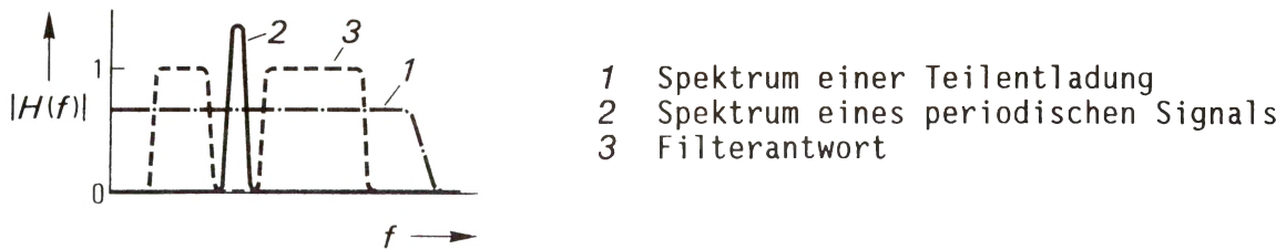
Bild 2: Übertragungsfunktion eines Teilentladungsmeßgerätes mit einer zusätzlichen Bandsperre
