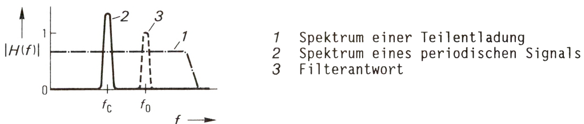
Bild 1: Übertragungsfunktion eines schmalbandigen Meßgerätes
