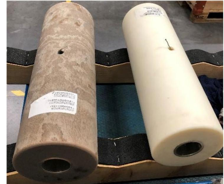
RIS- und RIP-Testkörper ohne Isolation, vollumfänglich in Wasser eingetaucht.
