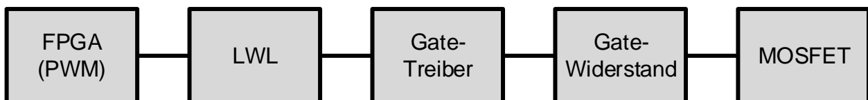
Bild 3: Blockschaltbild einer Ansteuerkette für einen Leistungstransistor
