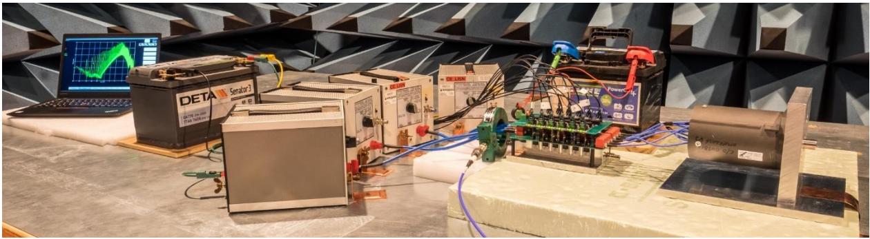
Bild 2: Komponententest nach CISPR 25 zur Beurteilung der Emission des Inverters
