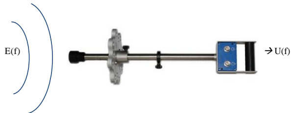
Bild 2 UHF-TE-Sensor für den Kesseleinbau über DN-80/50 Ölschieber mit einfallender elektromagnetischer Welle und resultierender Antennenfußpunktspannung.
