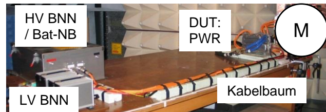
Bild 3 Messaufbau zur Bestimmung der EMV eines HV-Pulswechselrichters auf Komponentenebene
