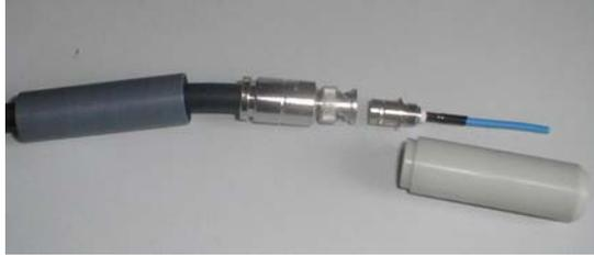
**Bild 13** Sensoraufbau: Stabantenne in der PVC-Hülle
