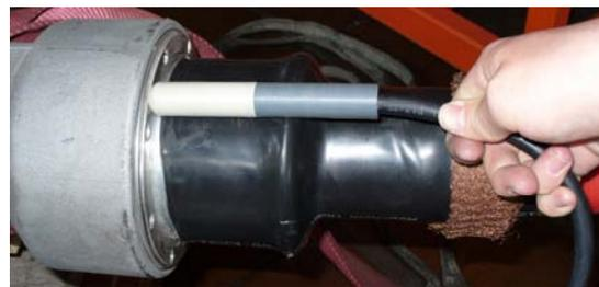
**Bild 12** „Mobiler“ Sensor im Einsatz
