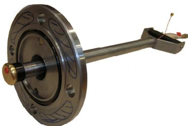
**Bild 1** UHF-Kegelsensor mit Schubstange, Gehäuse und Flansch für die Online-Messung
