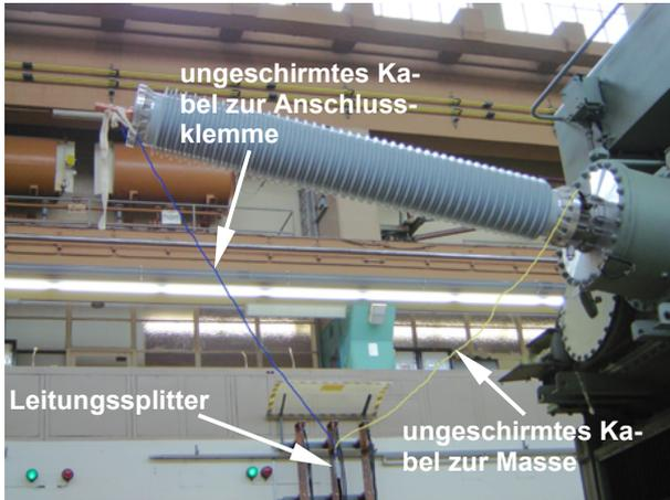
Abb. 10: Signalleitung unter der Durchführung hängend
