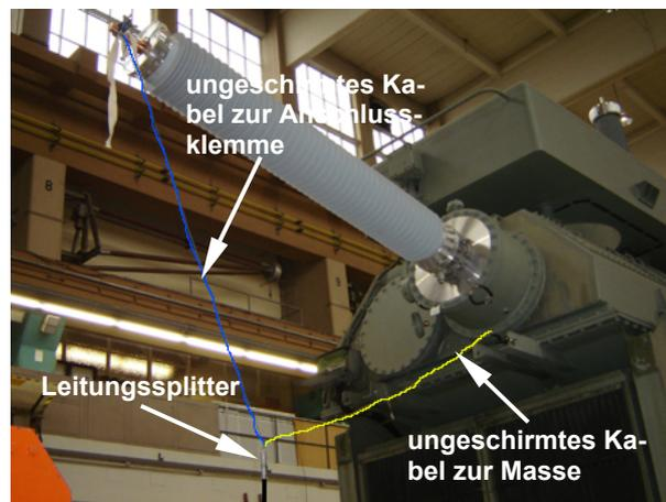
Abb. 12: Signalleitung unter der Durchführung hängend und neuer Anbindung an den Trafo
