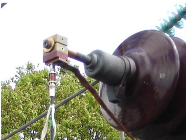
Abb. 14 a): Massiver Messing-Klotz als N-Trafoklemme-Adapter
