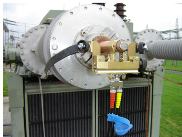
Abb. 14 b): BNC-Trafoklemmen-Adapter leichter Bauweise mit einstellbaren Bolzenumklammerung
