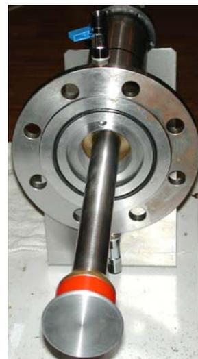
**Bild 1** Scheibenförmiger UHF-Sensor, der über zur Ölbefüllung benutzte Flachkeilschieber (DN 80) ins Transformatorinnere geschoben wird
