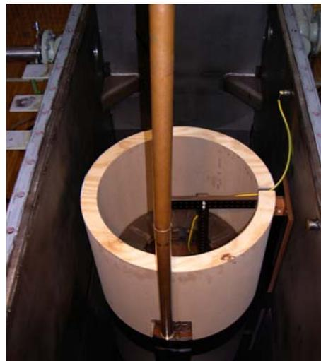
**Bild 5** Experimenteller Aufbau: Spule an Hochspannung mit stimulierter TE an bekannter Stelle umgeben von doppeltem Pressboard-Zylinder (Deckel aus illustrativen Gründen abgenommen)
