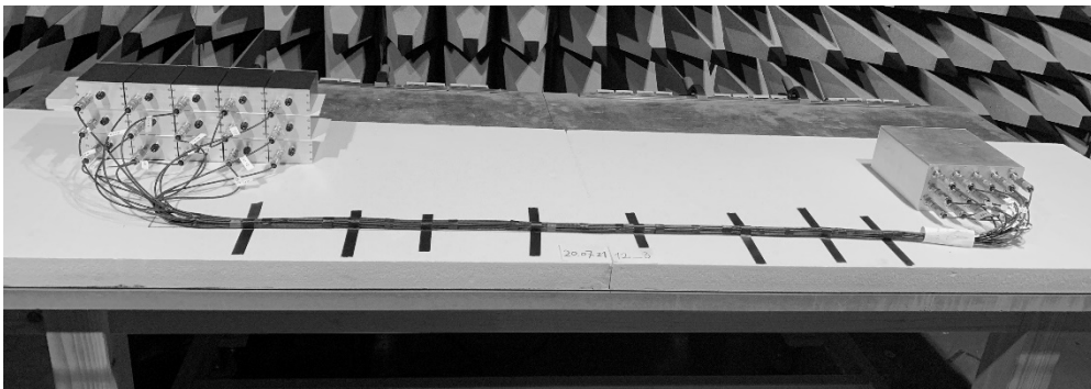
Fig. 1: Messaufbau mit 15 Busleitungen Measurement setup with 15 bus lines
