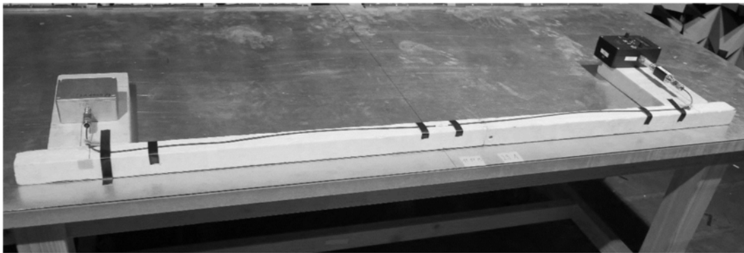
Fig. 1: Prüfaufbau für die Messung gestrahlter Emissionen nach CISPR 25. Setup for the measurement of radiated emissions acc. to CISPR 25.
