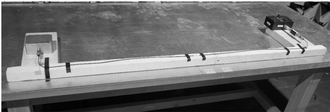
Fig. 1: Prüfaufbau für die Messung gestrahlter Emissionen nach CISPR 25. Setup for the measurement of radiated emissions acc. to CISPR 25.
