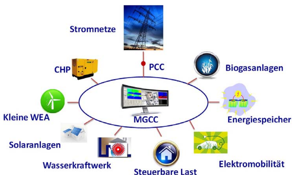
Fig. 1: Allgemeines Konzept eines Mikronetzes mit verschiedenen Bestandteilen General Concept of Microgrids with Different Components
