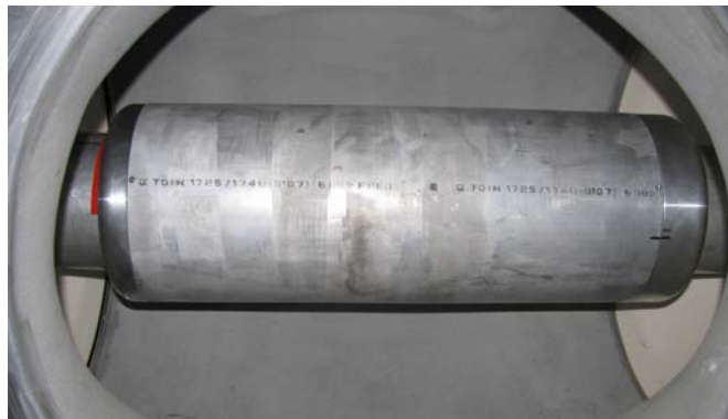
Fig. 2: Versuchsaufbau mit Hohlraumresonator in der GIS Test setup with cavity in GIS
