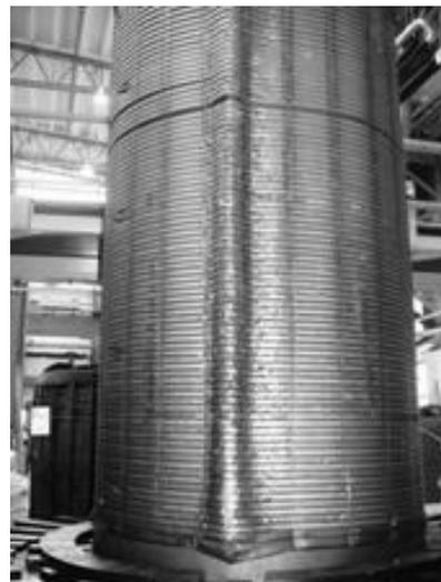
Fig. 1: Kurzschlusschaden (Radiale Deformation) an 220-kV-/110-kV-Wicklung
