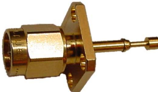
Fig. 1: SMA-Hochfrequenz-Stecker mit Federkontakt-Innenleiter
