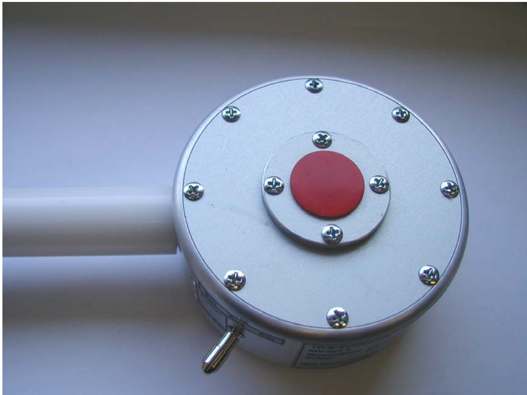
Fig. 1: Potentialfreie elektrische Feldsonde mit optimierter Sensorgeometrie und Abschirmelektrode Potential-free electric field probe with optimized sensor and field screening electrodes
