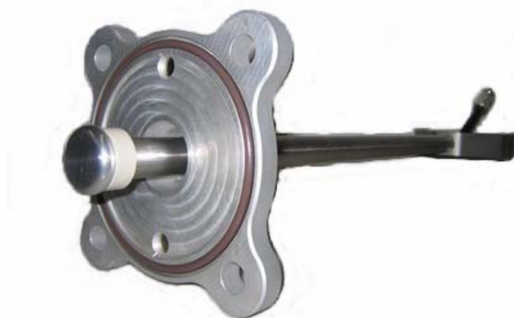
Fig. 1: UHF-Kegelsensor für die Online Messung mit Schubstange, Gehäuse und Flansch
