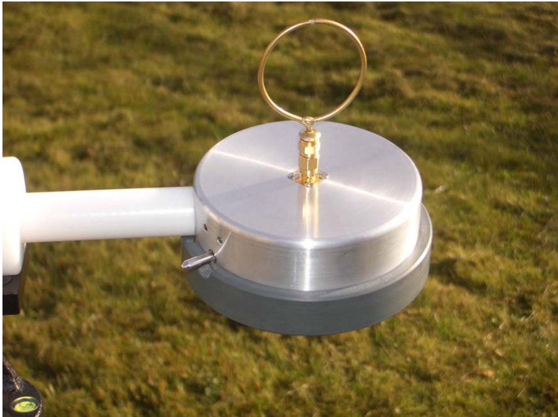
Fig. 3: Potentialfreie magnetische Feldsonde mit optimiertem Gehäuse und Elektronikleiterplatte Potential-free magnetic field probe with optimized housing and electronic PCB
