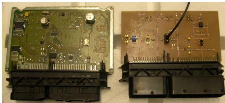
Fig. 1: Original control unit (left) and simplified test setup (right) Original-Steuergerät (links) und vereinfachter Messaufbau (rechts)
