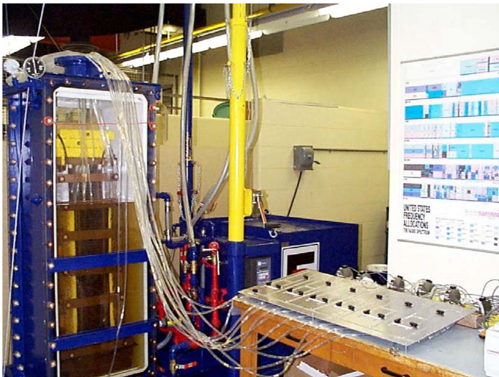
Fig. 2: Hydraulic test set-up with a disc-type winding model in the tank Hydraulischer Messstand mit einer Scheibenwicklung im Messtank
