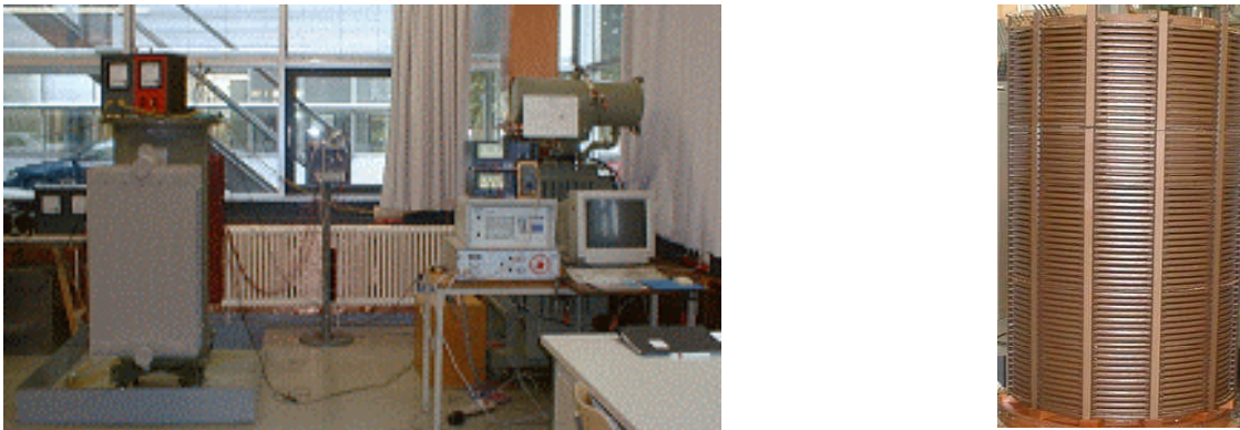
Fig. 1: Versuchsaufbau (links) und untersuchte Scheibenwicklung (rechts) Experimental setup (left) and examined test winding (right)
