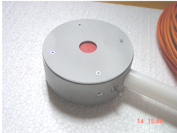
Fig. 2: View of the one-dimensional electrical field probe Foto der realisierten eindimensionalen elektrischen Feldsonde
