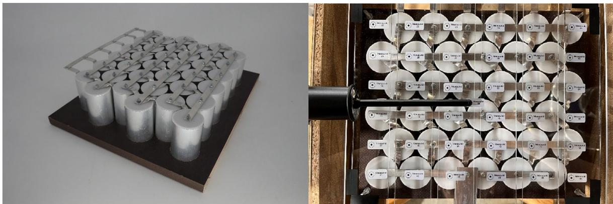
Fig. 1: Nachbau Batteriemodul (links) und Messung mit H-Feld-Sonde (rechts)
