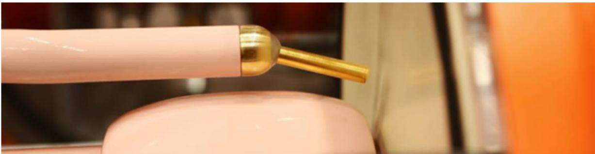
Fig 1: Feldsonde vor einem Stützer
