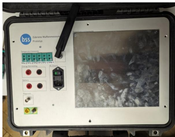
Abbildung 3.4-2 Gesamtsystem zur Messung der Temperaturen, des Stromes und von Teilentladungen
