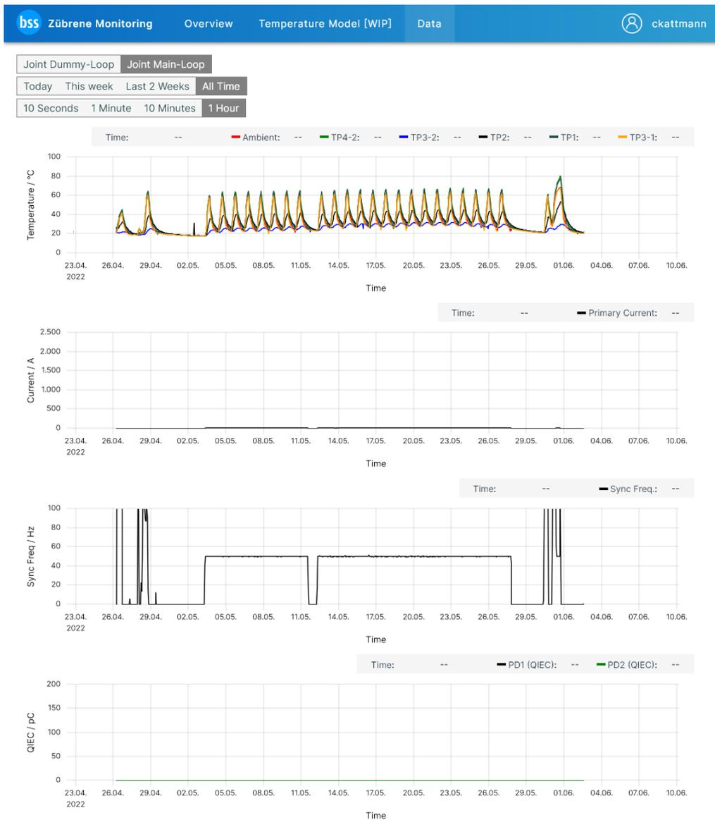
**Abbildung 3.4-5 Datenübersicht auf der Monitoring-Website. Im obersten Plot sind die Heizzyklen eines fast 1-monatigen Belastungstests für die intelligente Muffe zu sehen.**
