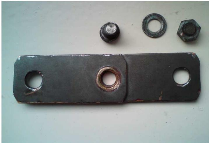
Abbildung 34: Im Hochtemperaturofen verzünderte Sammelschienenverbindung.
