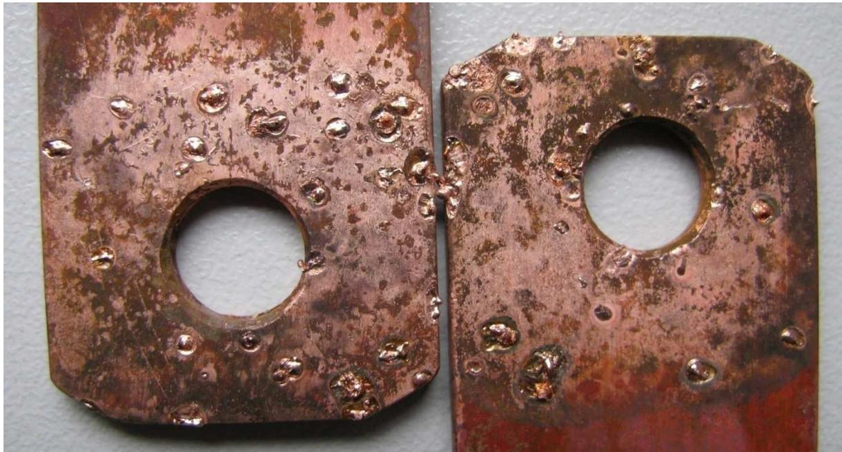
Abbildung 39: Aufgeschmolzene Lichtbogenfußpunkte zwischen den überlappenden Kontaktflächen.
